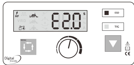
图 8 后气时间（连续点焊）
