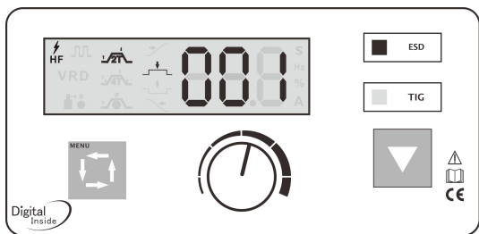
图 9 点焊时间（连续点焊）
